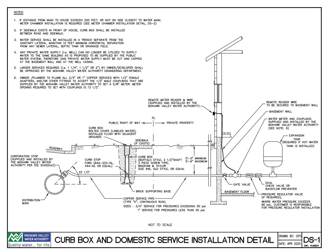
Z: \CAD Drawings\Standard Details\Typical Domestic Service\dwg\DS1.dwg
